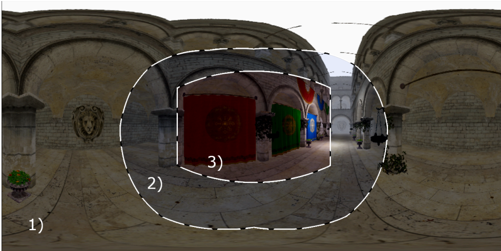
Figure A.22 – Comparaison des champs visuels couverts par 1) la projection équirectangulaire, 2) le champ visuel humain binoculaire (bleu clair), 3) une projection perspective classique (rouge clair).
