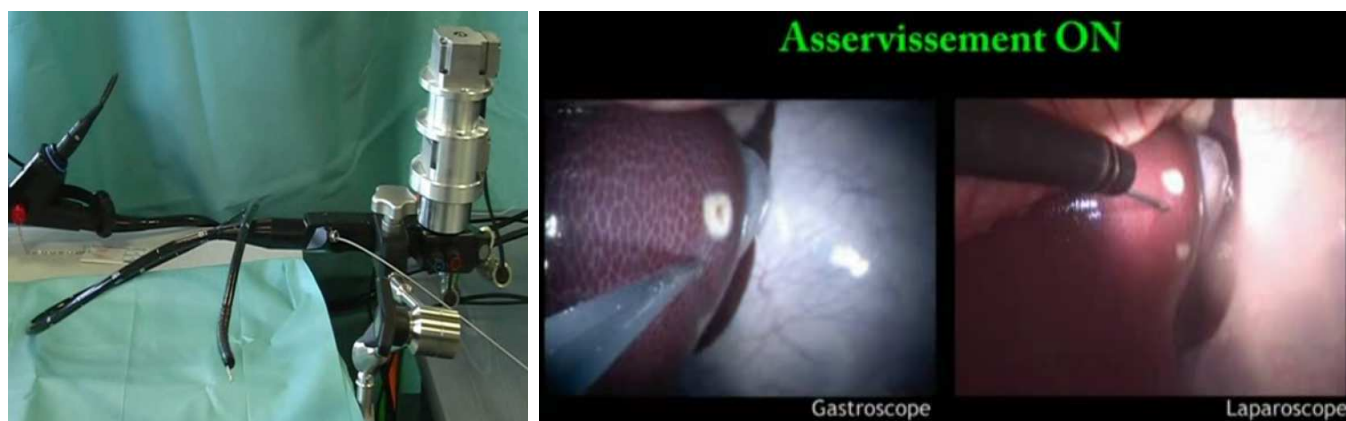
Fig. 3. Gastroscopie robotisée - Image observée durant l'asservissement visuel par l'endoscope flexible (gastroscope). L'orientation de la tête est automatique afin de suivre un point de brûlure du foie (tâche blanche) alors que l'enfoncement du gastroscope et des instruments est manuel - Vue du gastroscope et de son instrument par un laparoscope conventionnel
