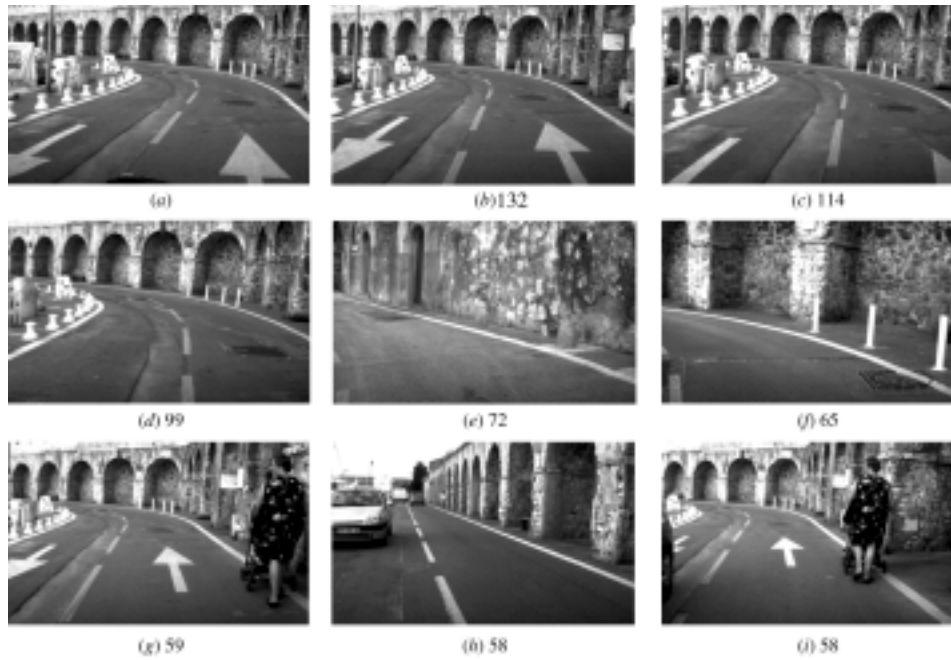
Figure 4. Localisation qualitative par recherche d'images. (a) : image requête, (b) à (i) : plus proches vues trouvées dans la base. Les nombres entre parenthèses représentent le nombre de voix obtenues par chacune des vues. Les images sont de dimension 728 \times 440 .
