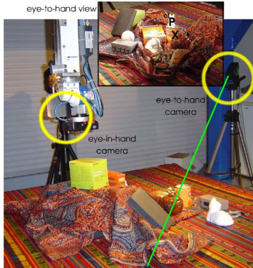
FIG. 6 – Dispositif expérimental : la scène est complexe. Les positions des deux caméras sont entourées d’un cercle jaune. En haut à droite : vue de la caméra déportée avec le point sélectionné {}^{cf}p . La ligne verte est la ligne de vue associée à {}^{cf}p
