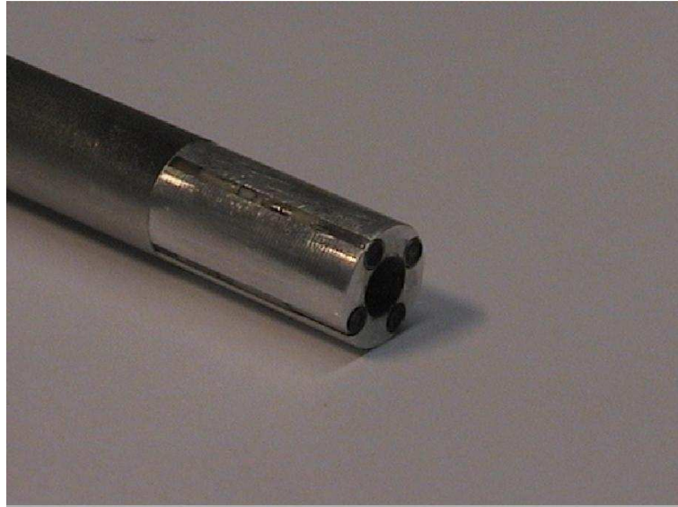
Fig. 2.3: Tête du support à pointage laser
