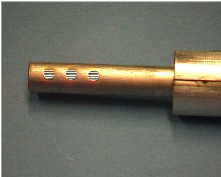
Fig. 2.6: Marquage optique de l'instrument chirurgical
