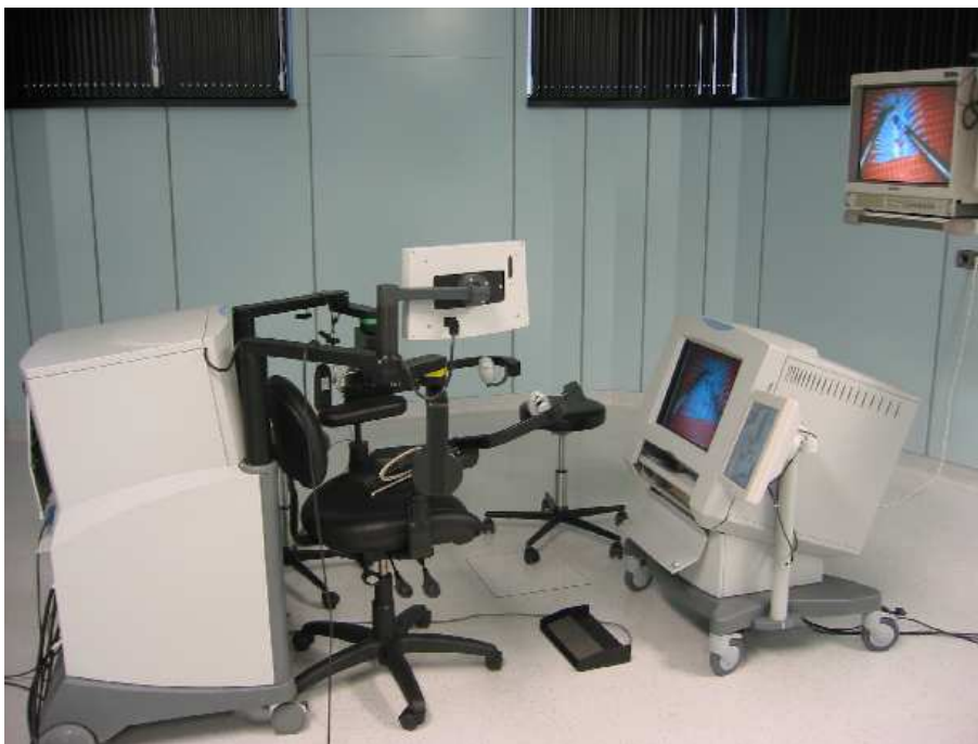
Fig. 1.13: Le système ZEUS : la console de commande composée du robot maître et de l'écran vidéo
