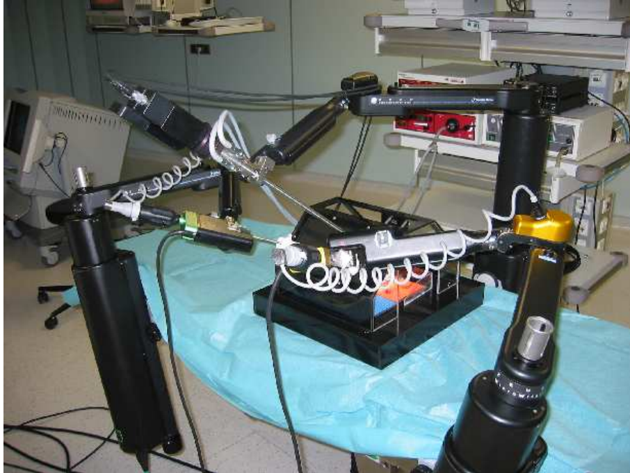
Fig. 1.12: Le système ZEUS : les manipulateurs esclaves
